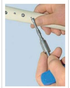
2 Select the corresponding Relief Cutter (CES-RC-01/14 and attach to the Straight or Offset "T" handle (CES-1-03/04 or alternatively to the Power Adaptor (CES-1-08).
